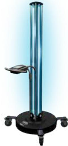
UV-C 紫外線照射システム UVDI-360 は、通常オゾン層によって遮られることで地上には届かない UV-C を、UV ランプによって人工的に放射できるようにしたシステムです。UV-C は、微生物の再生プロセスを遮断することにより、微生物を不活化させる効果を持っています。UVDI-360 で使用している 254nm という波長は、UV-C 帯域の中でも特にこの効果が高い波長とされています。
