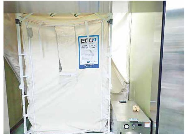
手術時の清浄な環境を保つためには、高性能フィルターからの清浄な空気を送り出す「高機能の空調」、外部からの空気の流れ込みを防ぐための「陽圧管理」が必要です。
